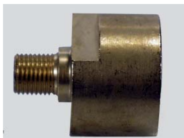
30 252 01 Dieser ADAPTER wird benötigt, wenn Fremdbohrer (Belgisches Gewinde) in unserem System verwendet werden sollen (1/2" Außen, 10 mm Innen). This adapter is required if foreign drill bits (Belgian thread) are used with our system (1/2" outside, 10 mm inside).
