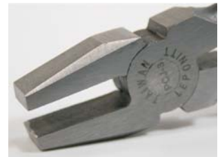
32 132 00 PROVETRO PCJ-3 Brechzange, schmal, 165 mm 12 mm Backenbreite, (ideal für 2 - 6 mm Glas)
