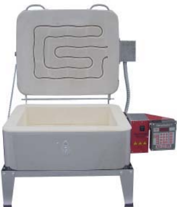
35 163 20 PROVETRO-Ofen GT4050 RM 3,2 KW / 230 V CE mit Thermocomputer "Ramp Master" temperature computer "Ramp Master" Innenmaße: / Inner dimensions 50 x 40 x 16 cm
