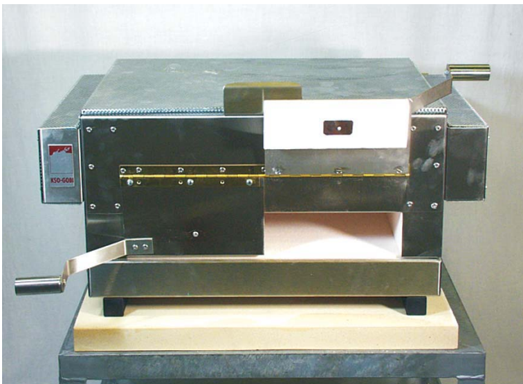
38 410 00 Perlen Kühlöfen / Bead annealing kiln, 230 V / 1,6 kw Innenmaß/Inner dimensions: 40 x 33 x 13 cm mit Bentrup Steuerung TC 60-8 /with Bentrup controller TC 60-8
