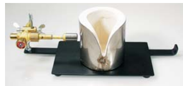
38 103 00 Volcano Set, komplett mit Brenner und Schmelzkammer Volcano set, complete with torch and oven
