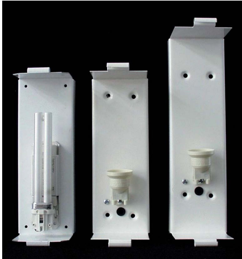
20 276 01 Wandhalter, einflammig, für PL-Technik 5 - 11 Watt, (Lieferung ohne Leuchtmittel), Höhe: 23 cm, Abstand Wand-Glas: 9,5 cm, (für gebogene Lampenschirme: Fusingformen 35 228 00, 35 225 61, 35 225 56) Wall fixture, 1 - light, for PL technique 5 - 11 watt, (light bulb not included), height: 23 cm, distance wall-glass: 9,5 cm, (fits curved wall shades: fusing molds 35 228 00, 35 225 61, 35 225 56)
